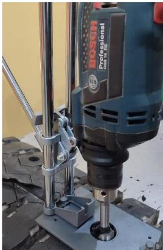
Fig 14. Perforación con taladro en banda de rodado. Elaboración propia
