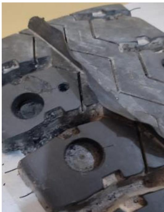
Fig 13. Perforación en banda de rodamiento. Elaboración propia
